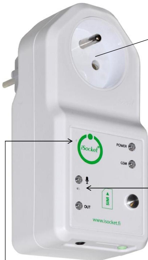
**Prise d'alimentation principale:** prise externe pour la connexion d'équipements électriques, qui peut être commandé à distance.
